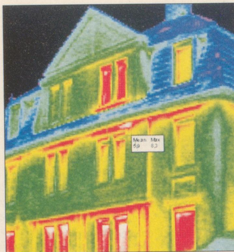
Thermografie-Aufnahmen zeigen die Wärmeverluste eines Hauses (rote Bereiche), grüne und blaue Farbtöne dagegen zeigen kühle Flächen.
