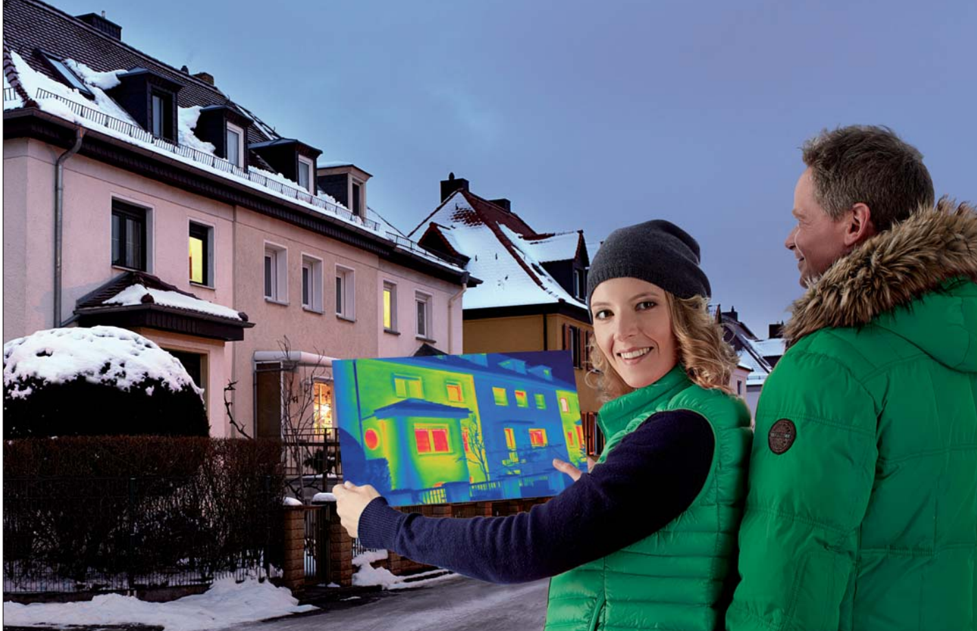
Die Infrarotkamera ermittelt gezielt Wärmeverluste an Gebäuden. Die Aufnahmen werden während der kalten Jahreszeit gemacht.
