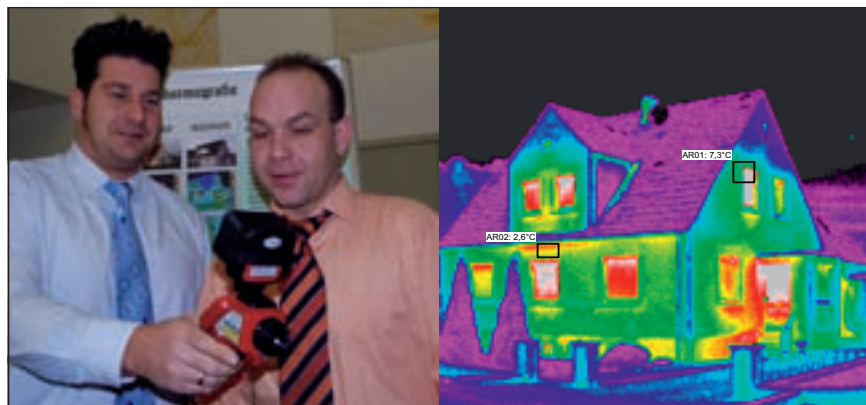
Die Gebäudethermografie zeigt, wo am Haus Energieverluste entstehen.
