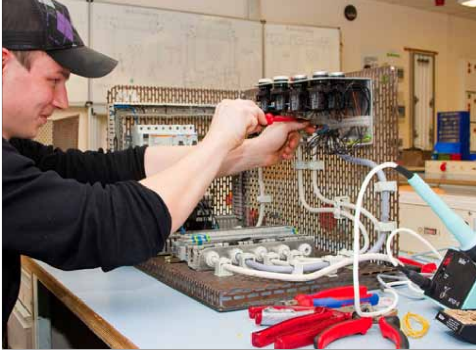
Letzte Handgriffe: Sebastian Szukowski dreht die Schrauben an seinem Schaltersystem fest.
