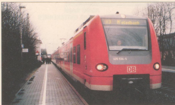
Der Triebzug ET der Baureihe 425 auf der Linie RE 3 im Bahnhof Kamen.
