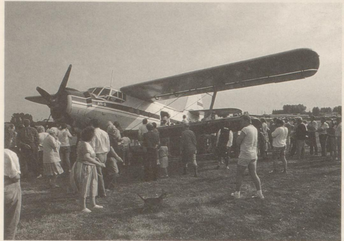
Der größte Doppeldecker der Welt, die „Antonow AN 2“ landete vor kurzem auf dem Flugplatz in den Lippewiesen. Der über 1000 PS starke Motor hat neun in Sternform angeordnete Zylinder. Die Maschine, die 1972 gebaut wurde, wird auch heute noch produziert (in Mielec, Polen). Eingesetzt wird der maximal 200 km/h „schnelle“ Vogel vornehmlich in der Landwirtschaft, für Fallschirmsprünge und für Transportflüge.
