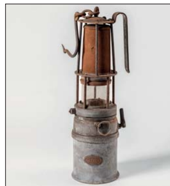
Diese Grubenlampe, genauer Benzinsicherheitslampe, stammt von der Zeche Radbod in Bockum-Hövel.
