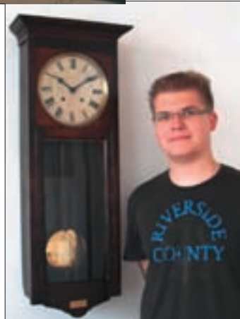
Die von Christian Schnurbus restaurierte Normaluhr trieb bis Ende 1944 die Uhren im alten Hammer Stadtbad an.
