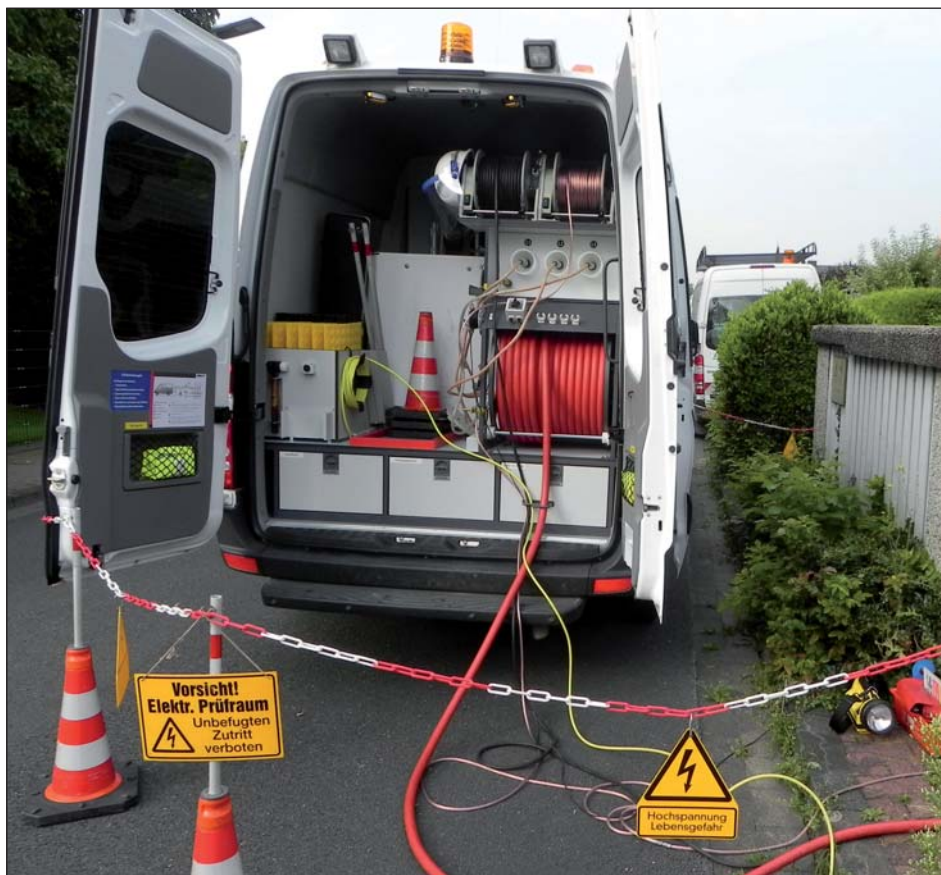
Lokalisieren punktgenau die Fehlerstelle: die Technik des Kabelmesswagens in Kombination mit dem äußerst sensiblen Bodenmikrofon
