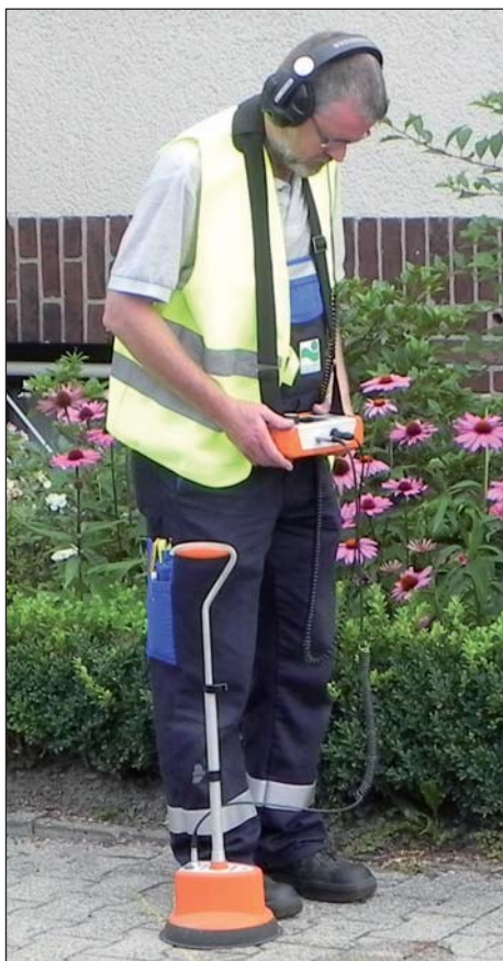
Lokalisieren punktgenau die Fehlerstelle: die Technik des Kabelmesswagens in Kombination mit dem äußerst sensiblen Bodenmikrofon
