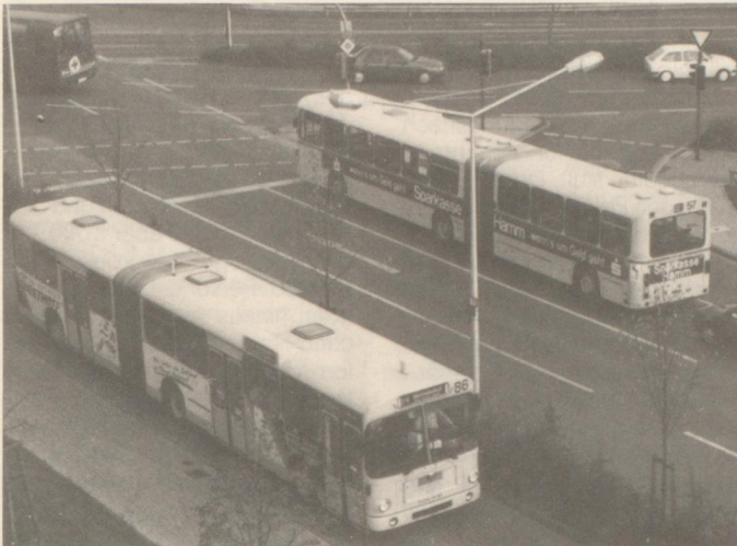
Busse benötigen nur einen Bruchteil des Verkehrsraumes, den Pkws für sich beanspruchen. Mit eigenen Spuren kann der ÖPNV wirksam beschleunigt werden. Foto: Lutz Rettig
