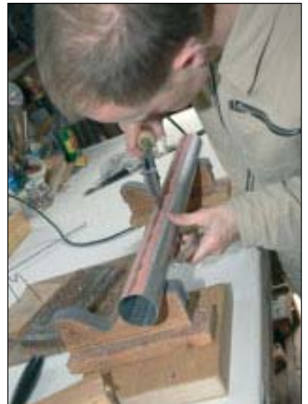
Mit Präzision: Herstellung der Pfeifen.
